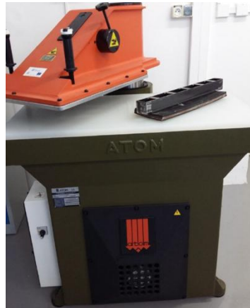
Fig. 1 Atom SE 25 hydraulic press and cutting die
